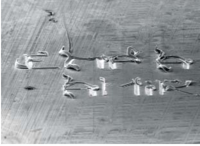
Strukturierung einer Oberfläche durch Scratching Structuring a surface by scratching
